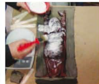
6 Appliquez une 1ère couche à l'aide d'un pinceau et laissez prendre
