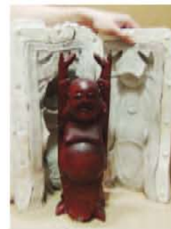
12 et enduisez le silicone apparent et la chape de vaseline pour que la couche suivante de silicone n'y accroche pas
