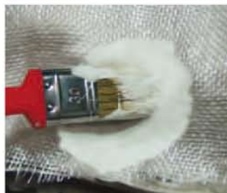
8 Avant durcissement de la 2ème couche, appliquez des bouts de verranne sur le moule avec un pinceau imbibé de white-spirit
