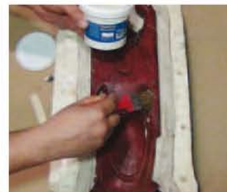
12 et enduisez le silicone apparent et la chape de vaseline pour que la couche suivante de silicone n'y accroche pas
