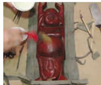
4 Appliquez de la vaseline sur le modèle et le muret
