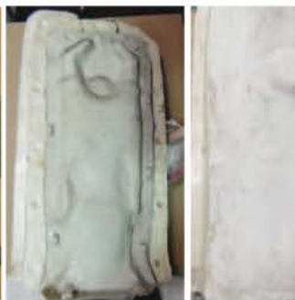
10 Coulez une chape de plâtre en ajoutant de la filasse pour maintenir et solidifier l'empreinte.
