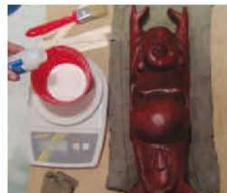
5 Mélanger le RTV 181 avec son catalyseur
