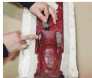
11 Après séchage de la chape, retournez la pièce, dégraissez le muret en terre
