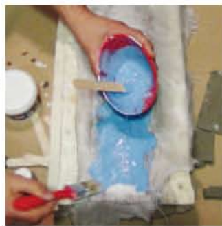
9 Couvrez toute la pièce en superposant le renfort, recoulez une autre couche. Le renfort évite les déchirures du démoulage. Lissez votre silicone après avoir chaussé une paire de gants trempés dans l'eau savonneuse.
