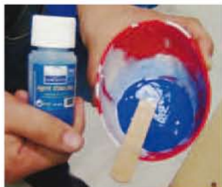
7 Appliquez la 2ème couche avec l'agent thixo pour les pièces à fortes contres-dépouilles
