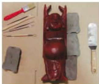
1 Préparez le modèle et faire le plan de joint
