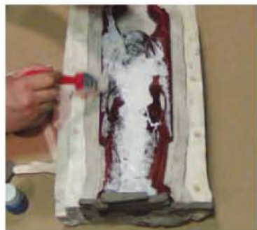
7 Appliquez la 2ème couche avec l'agent thixo pour les pièces à fortes contres-dépouilles
